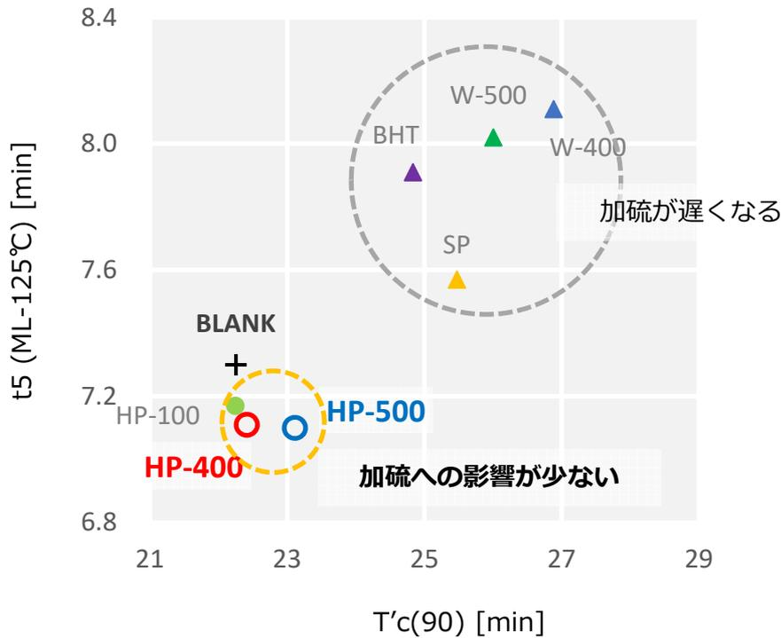
フェノール系酸化防止剤は一般にスコーチタイムおよび加硫が遅くなる傾向が見られます。
