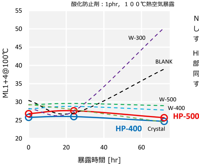
NBRは熱空気暴露すると高粘度化し、加工性を損なう欠点があります。
