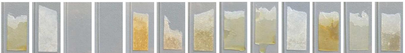
熱硬化劣化傾向を示すSBSは劣化後、被着体へ固着することがあり剥離することが難しくなります。
